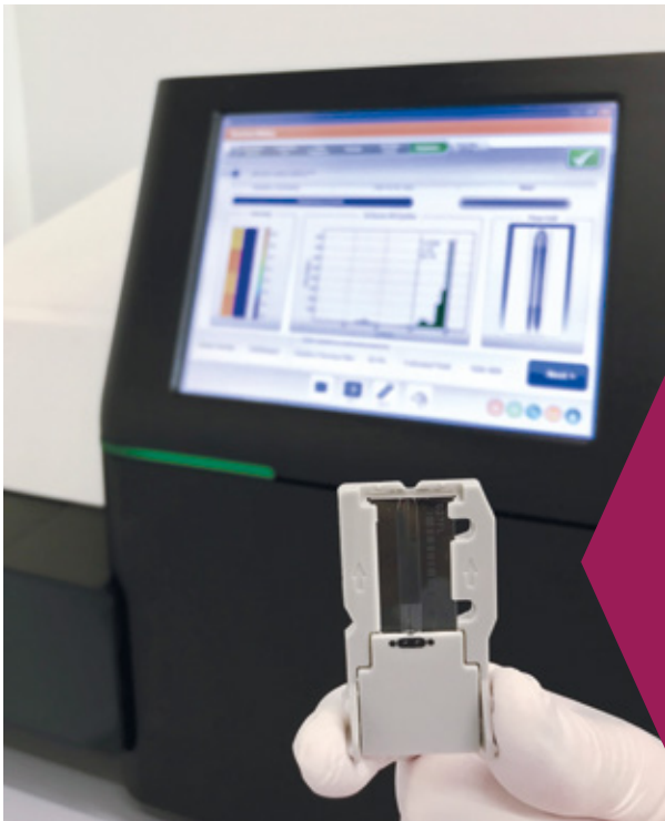
Abb. 2: Detektion einzelner Nukleotide während der Sequenzierreaktion: Im linken Teil der Abbildung ist die Fließzelle (Fa. Illumina®) dargestellt, auf der die SBS-Sequenzierreaktion stattfindet. Beim Einbau der passenden komplementären Nukleotide des zum kovalent an die Fließzelle gebundenen Fragmentes erfolgt gleichzeitig die photographische Detektion der Basenreihenfolge (SBS-Technologie). Ein heller Punkt auf dem für die jeweiligen Nukleotide separat aufgenommenen Bildern entspricht einem Cluster mit einem Durchmesser von ca. 1–3µm auf der Fließzelle.
